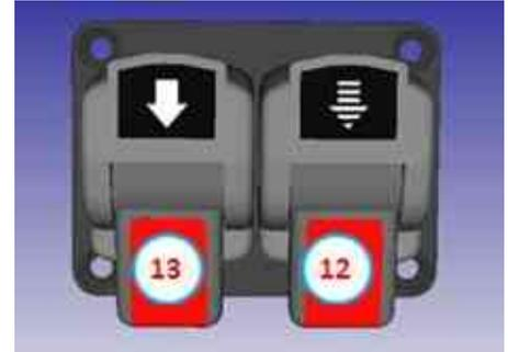
فى المركبات التى تحتوى صندوق قلاب, يتم إستخدام وحدة التحكم من أجل إنزال القلاب. و يُستخدم الزر رقم 12 للإنزال البطئ و الزر رقم 13 للإنزال السريع. و لرفع صندوق الشاحنة, يوجد زر PTO (ناقل الحركة الصغير).
