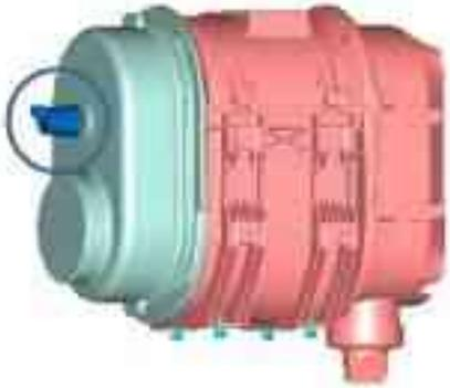
يتم توفير مؤشر خاص بالتلوث الكهربائي في المركبة. ينبغي أن يُرسل هذا المؤشر إشارة إلى لوحة أجهزة القياس ويقوم بتشغيل المصباح التحذيري عندما يتم امتلاء فلتر الهواء. وينبغي استبدال العنصر الأساسي للفلتر في هذه الحالة.
