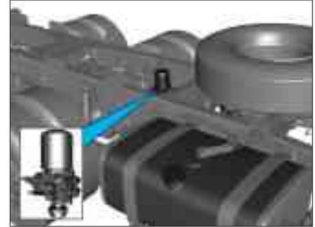
تتضمن وحدة مجفف الهواء في مركبتك وطاقف تسخين الهواء وفصل الزيت في الهواء وتفريغ الهواء وطاقف صمام التنقيح رباعي الاتجاه بجانب وظيفة تجفيف الهواء. يتوفر منفذ نفخ الإطار في مجفف الهواء داخل الشاسيه.
