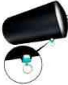
قم بتفريغ الماء من خزانات الهواء كل يوم. اسحب الحلقة المربوطة بالمحبس حتى يتم تفريغ كل الهواء لتصريف المياه داخل الخزانات.
