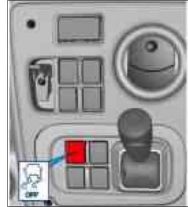
قد ترغب في تعطيل نظام ESP (المكابح ذات التحكم الإلكتروني) أثناء القيادة على الطرق الممهدة. في هذه الحالة، اضغط على مفتاح إلغاء نظام ESP (المكابح ذات التحكم الإلكتروني) الموجود في لوحة التحكم الوسطى.
