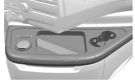
وحدة التحكم المركزية
